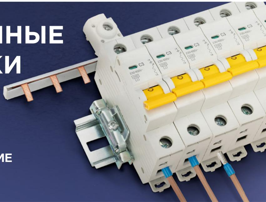
Предназначены для оконцевания многожильных медных проводов при монтаже электрических контактных соединений. Обжатие производится специальными пресс-клещами поверх защитного изолятора (арт. 12-3014; арт.12-3021). Применение изолированных наконечников значительно ускоряет электромонтажные работы, а также позволяет многократного отсоединять и присоединять провода.
